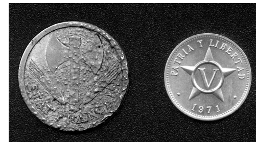
Рис. 9. Справа — не бывшая в обращении монета из алюминия (Куба, пять сентаво, 1971), слева — алюминиевая монета, подвергшаяся коррозии (Франция, два франка, 1943)
