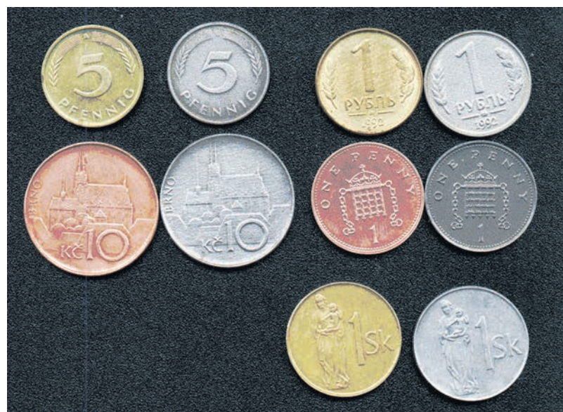
Рис. 2. Некоторые европейские монеты до и после растворения защитного покрытия. Слева направо и сверху вниз: 5 пфеннигов, ФРГ (1991); 1 руб. (1992); 10 крон, Чехия (1993); 1 пенни, Великобритания (1994); 1 крона, Словакия (1996)
