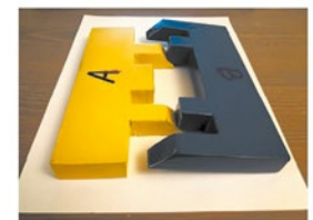
Рис. 5. Материал для изучения темы «Наклонные плоскости (клины) — нетранзитивные «гребенки» с профилированными зубьями. При фронтальном «наезде» гребенка А своим профилем зубьев поднимает гребенку В (она «сильнее»), В поднимает С, С поднимает А
