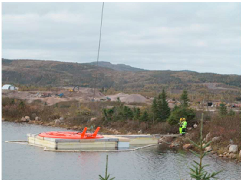
Платформа, имитирующая арктический лед, и нефтезадерживающий бон вокруг нее. Фото из статьи [1]
