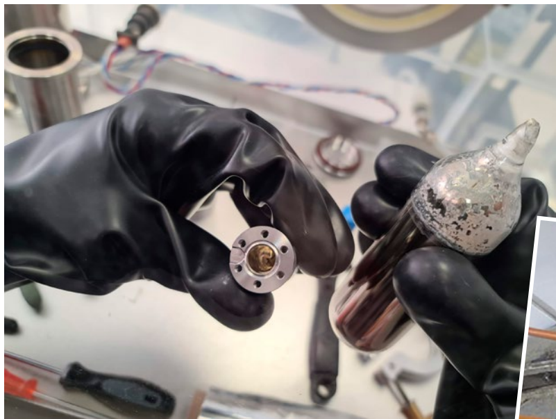
Наполнение металлическим цезием ячейки ионизатора ускорителя
